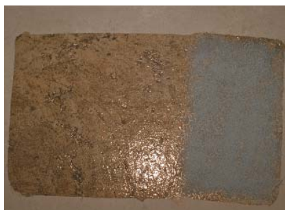
Fot. 2. Wygląd podłoża betonowego po naniesieniu środka gruntującego WEBAC 4270
