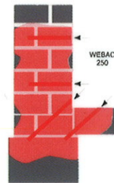
Zdjęcie 5: Schemat wykonania uszczelnienia strukturalnego.
