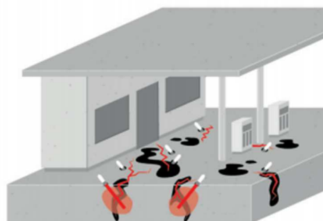
Naprawa rys zanieczyszczonych olejami/ tłuszczami
