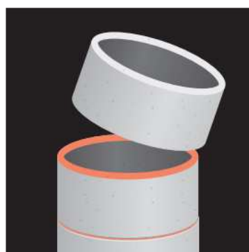
Przyklejanie betonu do betonu
