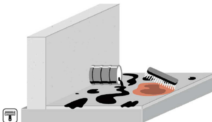
Czyszczenie zaolejonych podłoży
