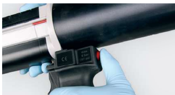
Druckentlastungsknopf vor Wechsel des Packers oder der Kartusche betätigen
