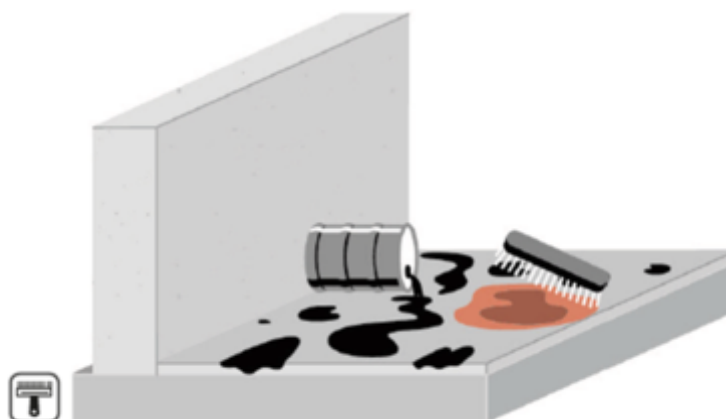
Czyszczenie zaolejonych podłoży
