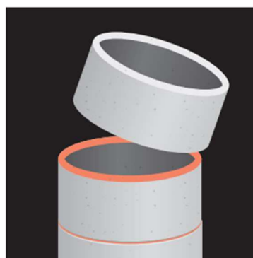
Przyklejanie betonu do betonu
