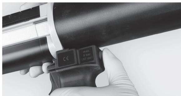
Druckentlastungsknopf vor Wechsel des Packers oder der Kartusche betätigen
